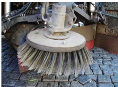
Bild 7. Stålborstar går hårt åt fogarna.
